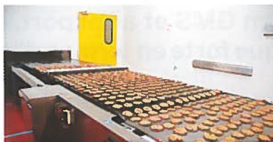
La cuisson (en four tunnel) des maxi cookies n'excède pas douze minutes.
